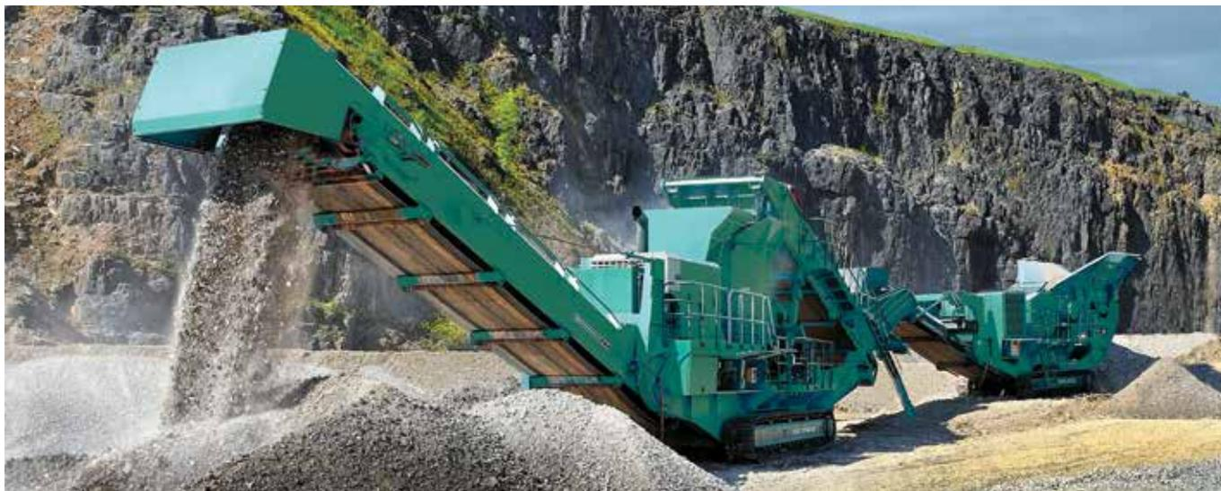
La unidad Powerscreen® 1500 Maxtrak es una de las trituradoras de cono más grandes del mercado. Desarrollada específicamente para los grandes usuarios, la máquina admite la alimentación integral de una trituradora primaria para producir grandes volúmenes de áridos.
