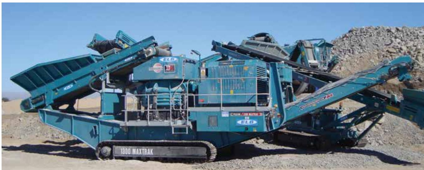
La unidad Powerscreen® 1300 Maxtrak es una trituradora de cono portátil de orugas de tamaño medio-grande idónea para aplicaciones secundarias tales como admitir una alimentación integral desde una trituradora primaria. Basada en la trituradora de cono 1300 Automax®, la máquina se destaca en la producción de materiales de subbase o áridos, con niveles excelentes de cubicidad, capacidad de producción y niveles de reducción.
